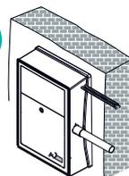
Um Wolly 2 an der Wand zu installieren, muss die Dose Art.-Nr. 7102.1 in den Abschlussrahmen Art.-Nr. 7102.2 eingesetzt werden.
